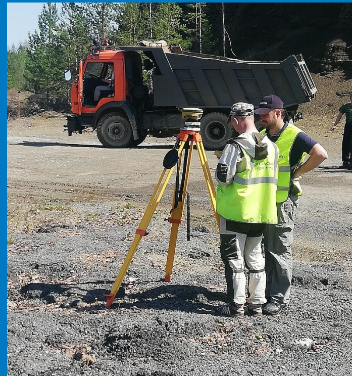
Запуск базовой станции экипажем дорожной фрезы
