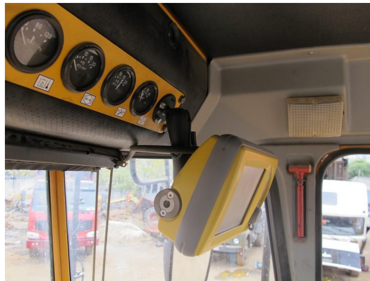
Крепление панели управления ПОД ПОТОЛКОМ
